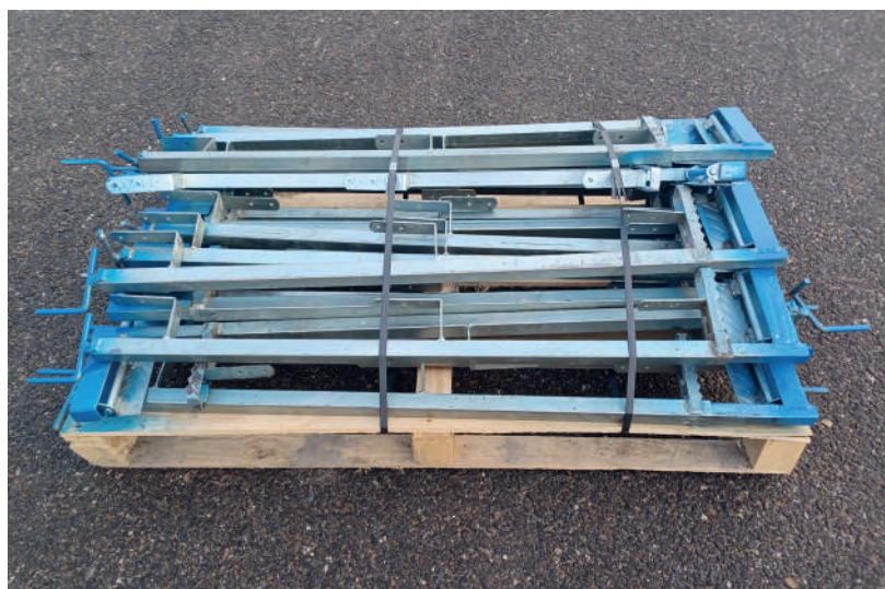
Esempio di stoccaggio dei parapetti in fase di consegna e reso:
